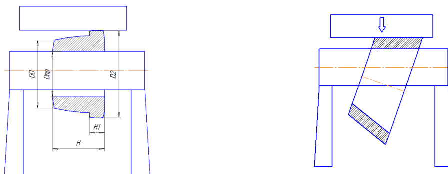
Рисунок 4.17 – Переходи кування конусної втулки
