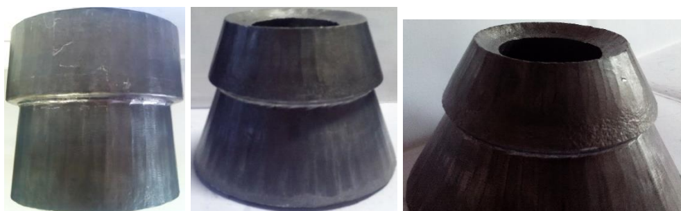
Рисунок 4.5 – Заготовки до розкочування з відносними діаметрами виступів D_B/d_0 : а – 2,6; б – 2,5; в – 2,4) та після розкочування (г–е) з відносним діаметром уступу 2,0 :
