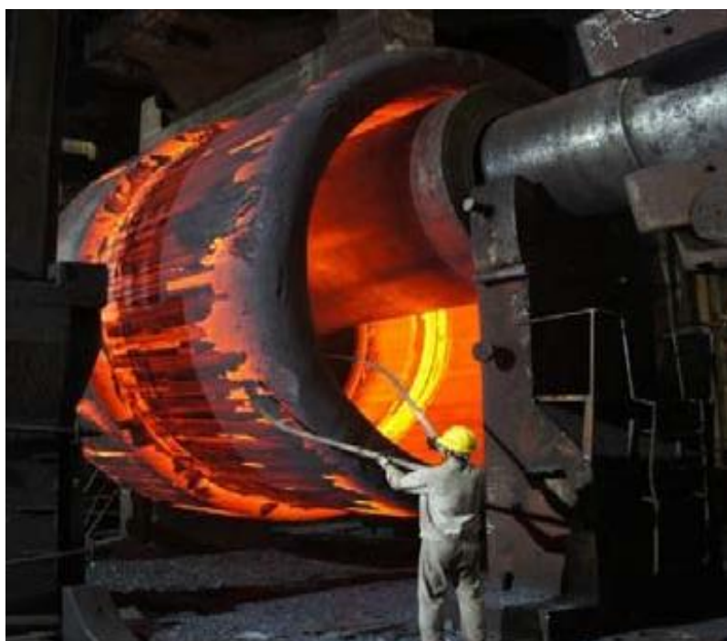
Рисунок 5.2 - Фото кування східчатої заготовки: а – початок; б - завершення
