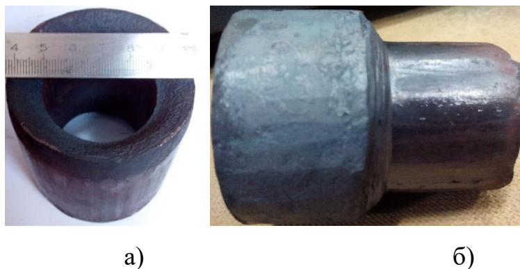
Рисунок 4.25 – Поковки після кування: а – базова технологія; б – нова технологія
